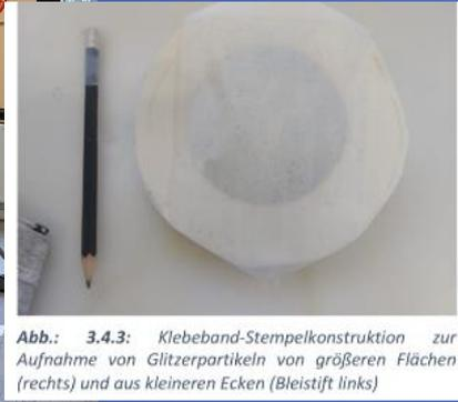
Abb.: 3.4.3: Klebeband-Stempelkonstruktion zur Aufnahme von Glitzerpartikeln von größeren Flächen (rechts) und aus kleineren Ecken (Bleistift links)
