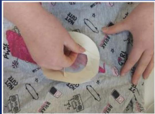
Abb. 3.4.2: Aufnahme von losen Glitzerpartikeln vom T-Shirt mit der Klebeband-Stempelkonstruktion
