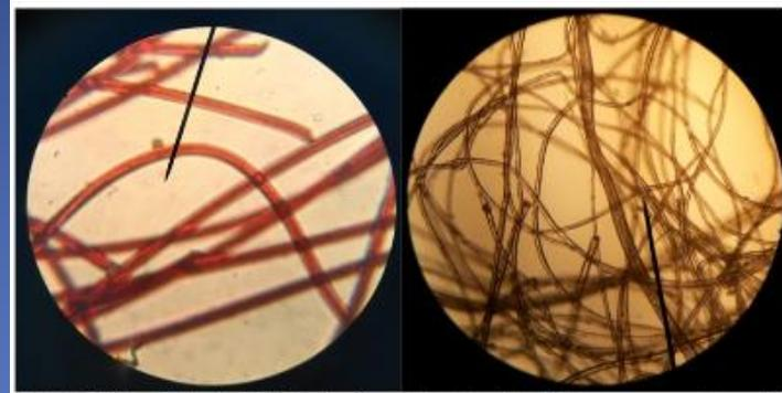
Abb. 4.1.2 links: Mikroskopie Polyester Garn mit glatter Oberfläche, rechts: Mikroskopie der unbehandelten Schafswolle mit ebenfalls glatter Oberfläche und zusätzlich Strukturen im inneren der Faser
